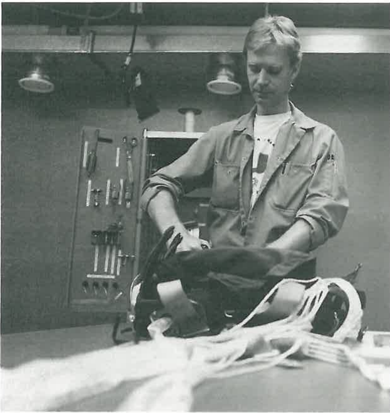
På säkmatverkstaden utför Lars Arvén tillsyn på en fallskärm 53.
