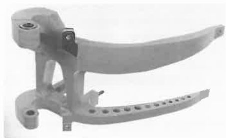
Reparerat fäste till FPL 37. Kostnadsbesparing c:a 800 000:-
